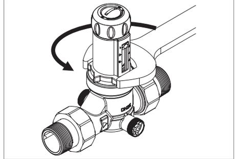
Reinigen Sie die Kartusche ausschließlich mit kaltem klarem Wasser.
