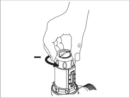
Öffnen und schließen Sie zur Druckentlastung eine nahe gelegene Zapfstelle.
