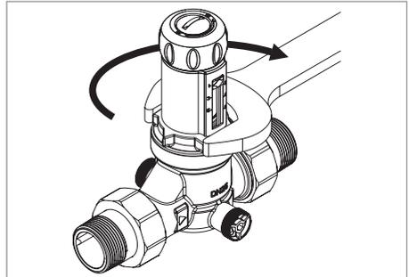
Öffnen Sie die Absperrungen, überprüfen Sie anschließend die Dichtheit und die Druckeinstellung.
