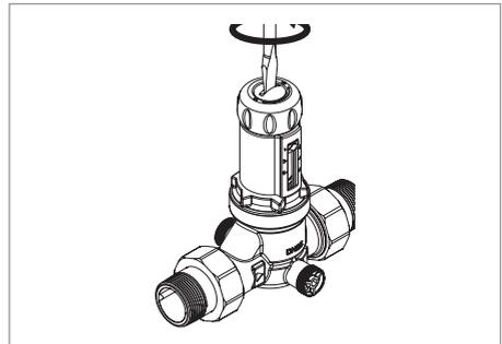
Drehen Sie den Griff bis zum Anschlag gegen den Uhrzeigersinn (Richtung „-“).
