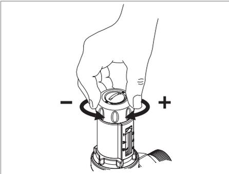
Wenn der Druck eingestellt ist, verriegeln Sie den Druckminderer wieder, indem Sie die Sechskantmutter im Uhrzeigersinn anziehen.
