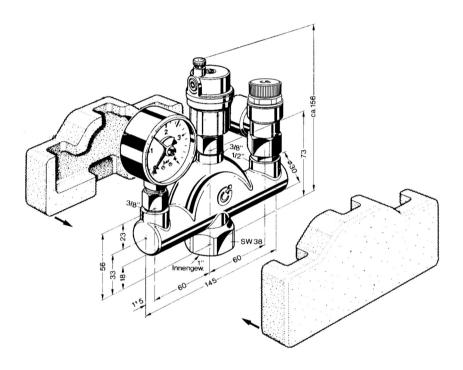
Die Kesselgruppe kann sowohl mit als auch ohne Isolierung geliefert werden. Die Isolierung ist auch separat erhältlich.
