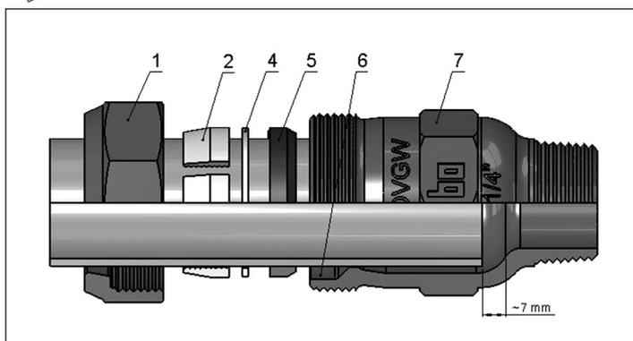
**(D) \*Einbaulänge beachten! Rohre dürfen nicht bis zum Anschlag eingeführt werden bzw. bei Kupplungen nicht aneinander stoßen**
