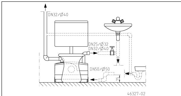
**HINWEIS!** Ein Verbindungsrohr zwischen WCFIX und Toilette führt zu Betriebsstörungen. Dieser Einbauzustand entspricht nicht der Zulassung des Deutschen Instituts für Bautechnik.
