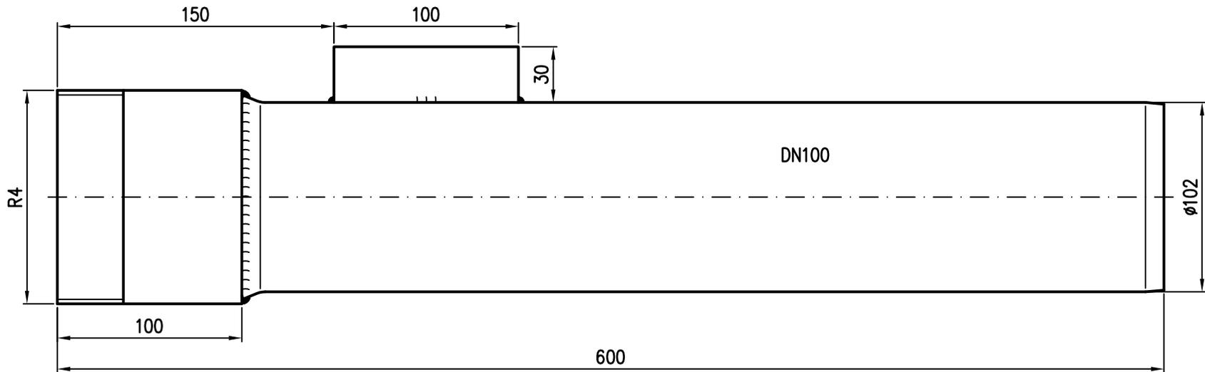
Werkstoff: E195 EN10305 feuerverzinktverzinkt und gebürstet
