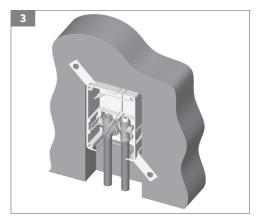
Beim Anschluss an das Rohrleitungsnetz ist auf spannungfreien Anschluss und auf die korrekte Fließrichtung (Vorlauf links - siehe Pfeilmarkierung!) zu achten. Vertauschte Anschlüsse führen zu Ventilgeräuschen und schlechtem Regelverhalten.
